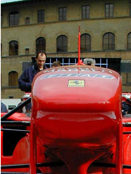
Esempio di Tubo di Pitot applicato sul musetto di una Ferrari da Gran Premio F1
