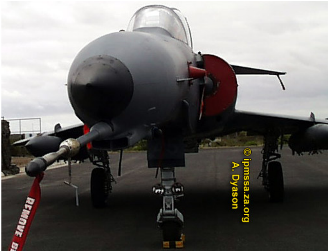
Esempio di Tubo di Pitot applicato sull'ogiva di un aereo militare
