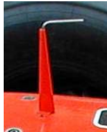
Esempio di Tubo di Pitot applicato sul musetto di una Ferrari da Gran Premio F1
